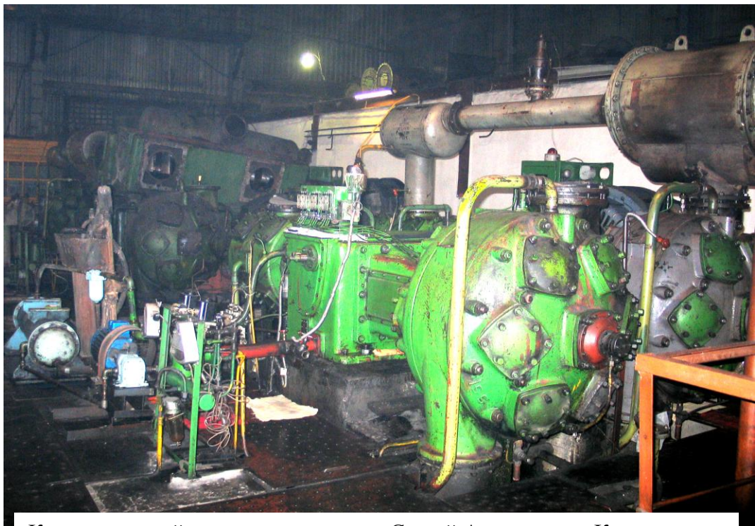
Компрессорный цех, начальник цеха Сергей Анатольевич Капельщиков. Коллектив этого цеха, с помощью мощных компрессоров, обеспечивает выработку пневмоэнергии для бурильных установок, работающих в забоях подготовительных выработок.
